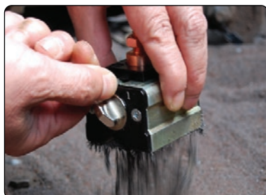
Wyłączanie uziemienia PowerBase™ Magnes i metalowe kawałki odpadają.
